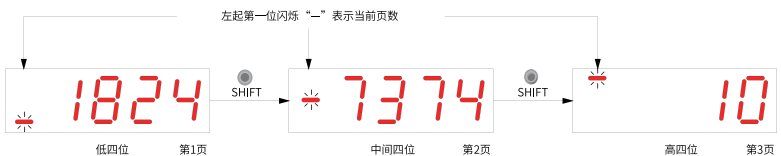
图1-4 1073741824显示操作示意图
