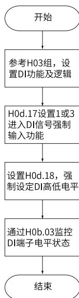
图1-6 DI信号强制输入设定步骤示意图
